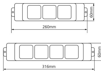
Las regletas Vario, destacan por su versatilidad de instalación. Gracias a sus aletas laterales, se pueden fijar debajo del tablero de la mesa o incluso atornillarlas a una pared.
