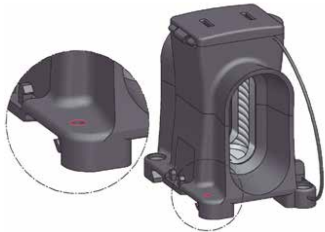
Sistema antitracción en carril mediante tornillo Ø3
