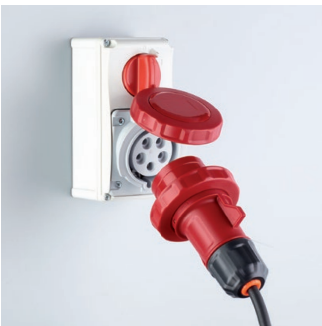
Después de puesto el switch en OFF y extraída la clavija, el mando queda bloqueado.
